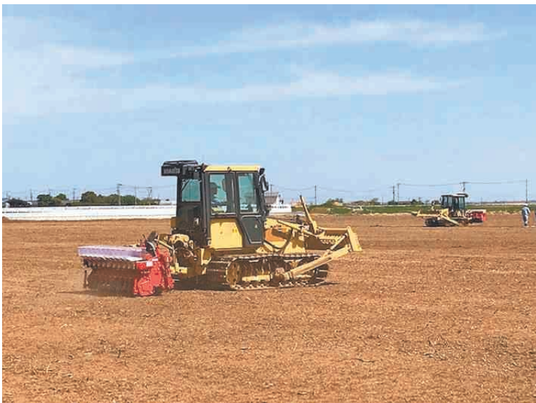
コマツが開発した農業用ブルドーザーを使った種まき作業＝稲敷市内（同社提供）
