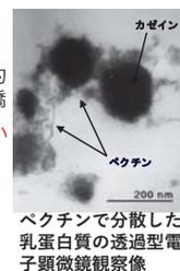
ペクチンで分散した乳蛋白質の透過型電子顕微鏡観察像
