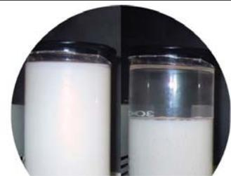
フロックが形成され沈降していく様子
