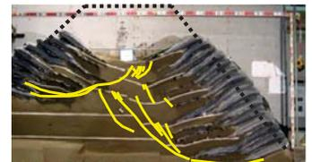
●100kgの特殊大型土のうを用いた高耐久ため池の三次元震動振動実験
