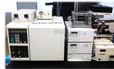
加圧高温水を 移動相とした クロマトグラフ
