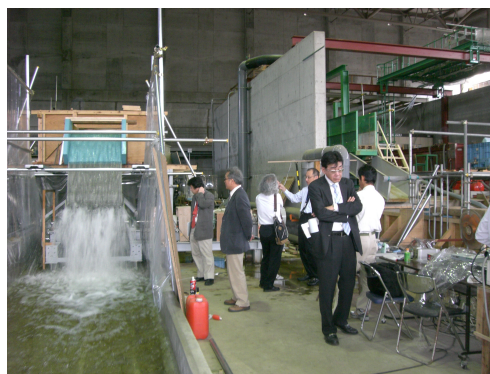
上掛け水車発電システム試作装置の性能試験
