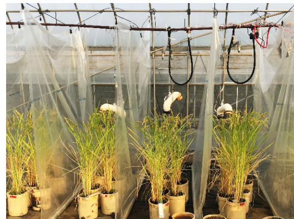
図2. スプリンクラーによる 稲体周囲への散水実験
